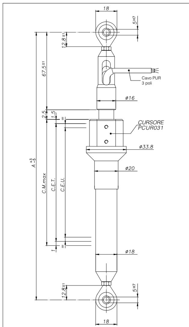
**Importante:** Tutti i dati riportati a catalogo per i valori di linearità, coefficienti di temperatura, sono validi per l'utilizzo del sensore come partitore di tensione con una corrente massima circolante nel circuito I<sub>c</sub> 0.1μA
